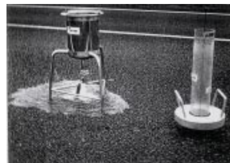
Figura 3: Permeámetro LCS (derecha) y permeámetro Zarauz (izquierda).
